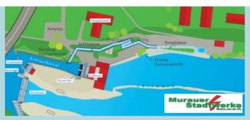
Die Ausgestaltung der Fischwanderhilfe erfolgte entsprechend den Erfordernissen der in der Mur vorkommenden Fischarten. Die Fischwanderhilfe hat eine Gesamtlänge von ca. 230m und besteht im oberen Bereich aus 22 Betonbecken, sogenannten Schlitzpässen, und im unteren Bereich aus 25 Tümpelpässen. Insgesamt wird mit einem Höhenunterschied zwischen den Becken von je ca. 20cm ein Gesamthöhenunterschied von ca. 9m überwunden.
